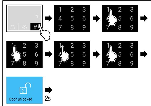
Fig. 85 Unlock the door with door code 1 1 1 1.
