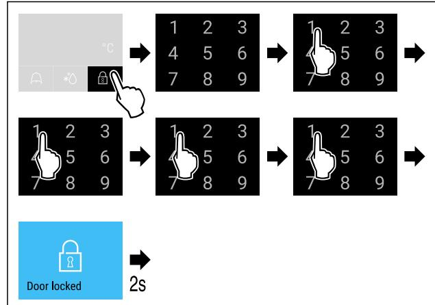
Fig. 82 Locking door using door code 1 1 1 1.
